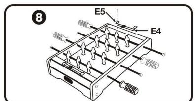
(GR) Τοποθετήστε τους δύο πίνακες βαθμολογίας (E4) στις αντίστοιχες με τη βοήθεια των κομματιών στερεώσης (E5).
