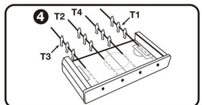
(GR) Εισαγάγετε τις μεταλλικές ράβδους (T1, T2, T3 και T4) στις οπές του μεγάλου πάνελ, όπως φαίνεται στην εικόνα.
