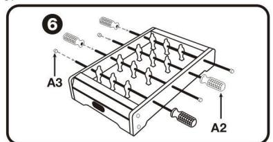
(GR) Σύρετε τις τέσσερις χειρολαβές (A2) και στερεώστε καλά τις τέσσερις τάπες (A3) στις μεταλλικές ράβδους, όπως φαίνεται στην εικόνα 6.
